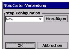
Jede Ntrip-Konfiguration enthält die Schlüsselinformationen, mit denen MobileMapper CX eine Verbindung zu einem bestimmten Ntrip-Caster aufbauen kann. Da Sie in MobileMapper CX mehrere Ntrip-Konfigurationen speichern können, können Sie den Ntrip-Caster schnell wechseln, ohne dass Sie die entsprechenden Verbindungsparameter jedes Mal neu eingeben müssen.
