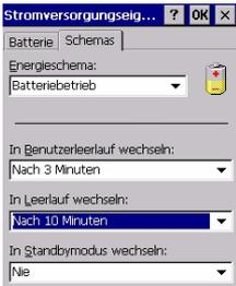
Sie können den MobileMapper CX Handheld so konfigurieren, dass er automatisch in den entsprechenden Modus wechselt, wenn er für eine bestimmte Zeit inaktiv war.
